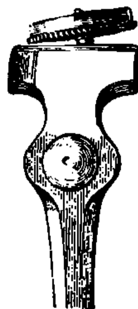
Fig. 128 - Bariletto tenuto in una morsa per controllare se gira dritto.
