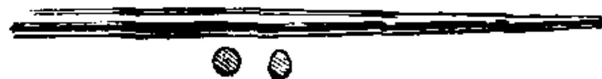
Fig. 256 - Brunitore per perni dell'asse del bilanciere.
