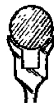
Fig. 65 Sezione del brunitore avente il medesimo diametro di quello delle corna.
