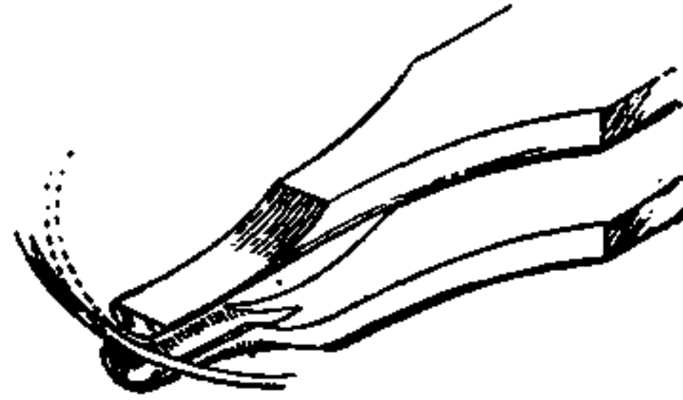
Fig. 229 - Pinzette impiegate per formare la curva.
