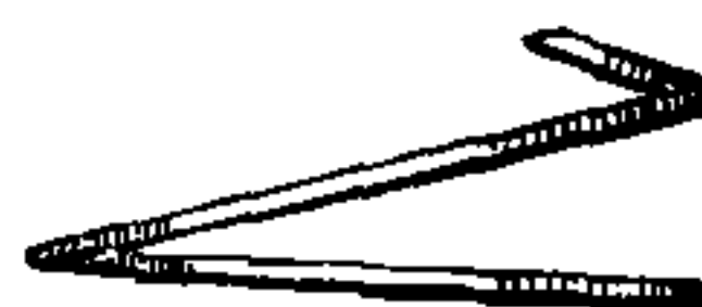
Fig. 223 - Come appare la spirale dopo il primo sollevamento.
