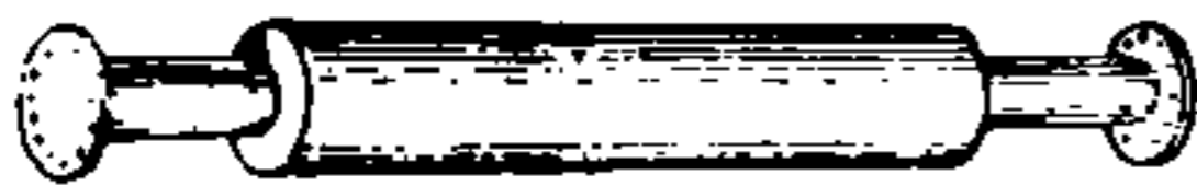
Fig. 325 - Tasso per arrotondare l'estremità dei perni.
