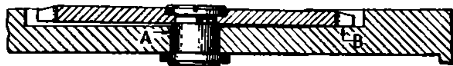
Fig. 181 - Foro di alloggiamento del perno dell'albero del bariletto (A) troppo grande che permette al rocchetto del bariletto di toccare la platina in (B).
