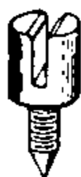
Fig. 197. Riduzione del peso di una vite del bilanciere.
