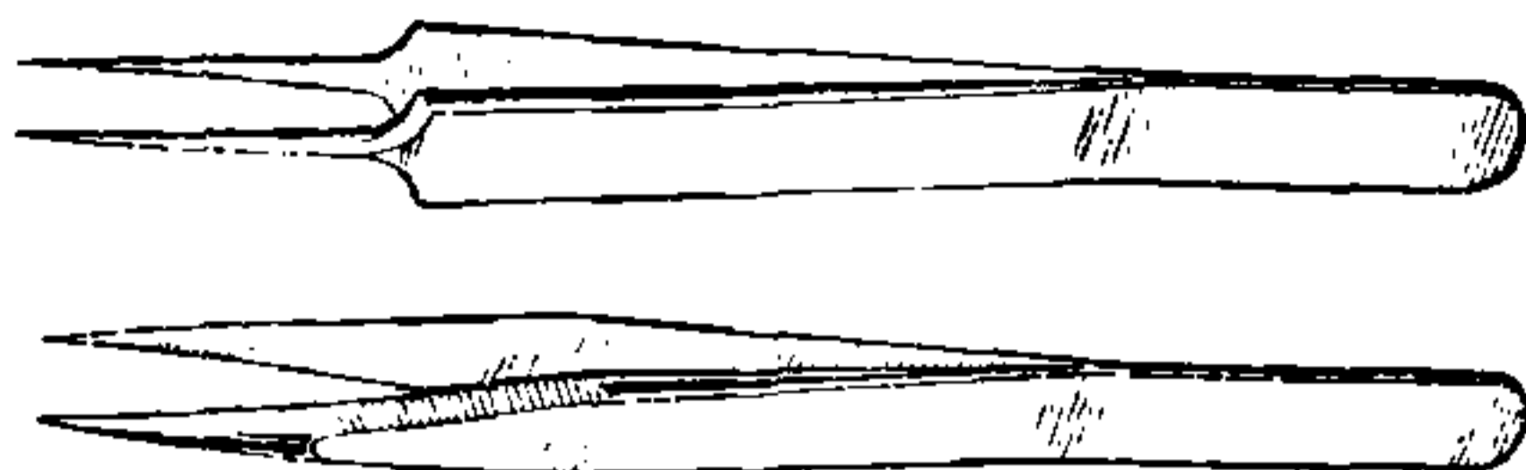
Fig. 8 - Forme consigliabili di pinzette a punte sottili.
