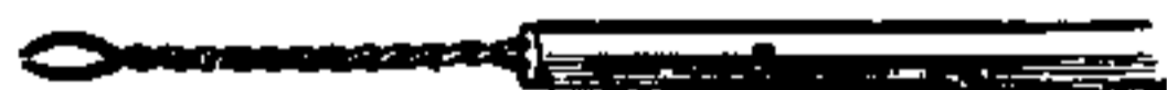
Fig. 70 - Utensile per scaldare la gommalacca che tiene in posto il bottone del disco.
