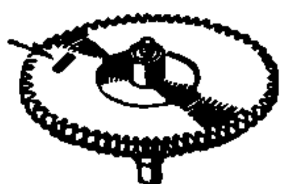
Fig. 471 - La freccia indica la spina della molla di trasmissione della forza.
