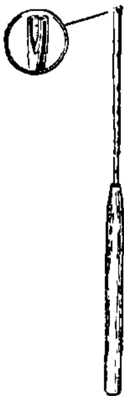
Fig. 206 - Utensile per troncare la parte interna della spirale.
