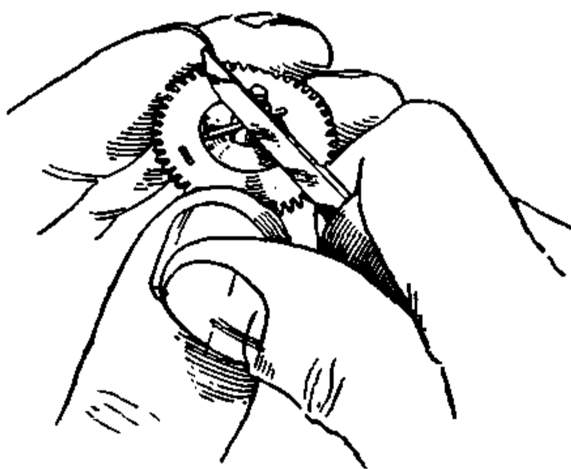
Fig. 470 - Spinatura del « fuso ».
