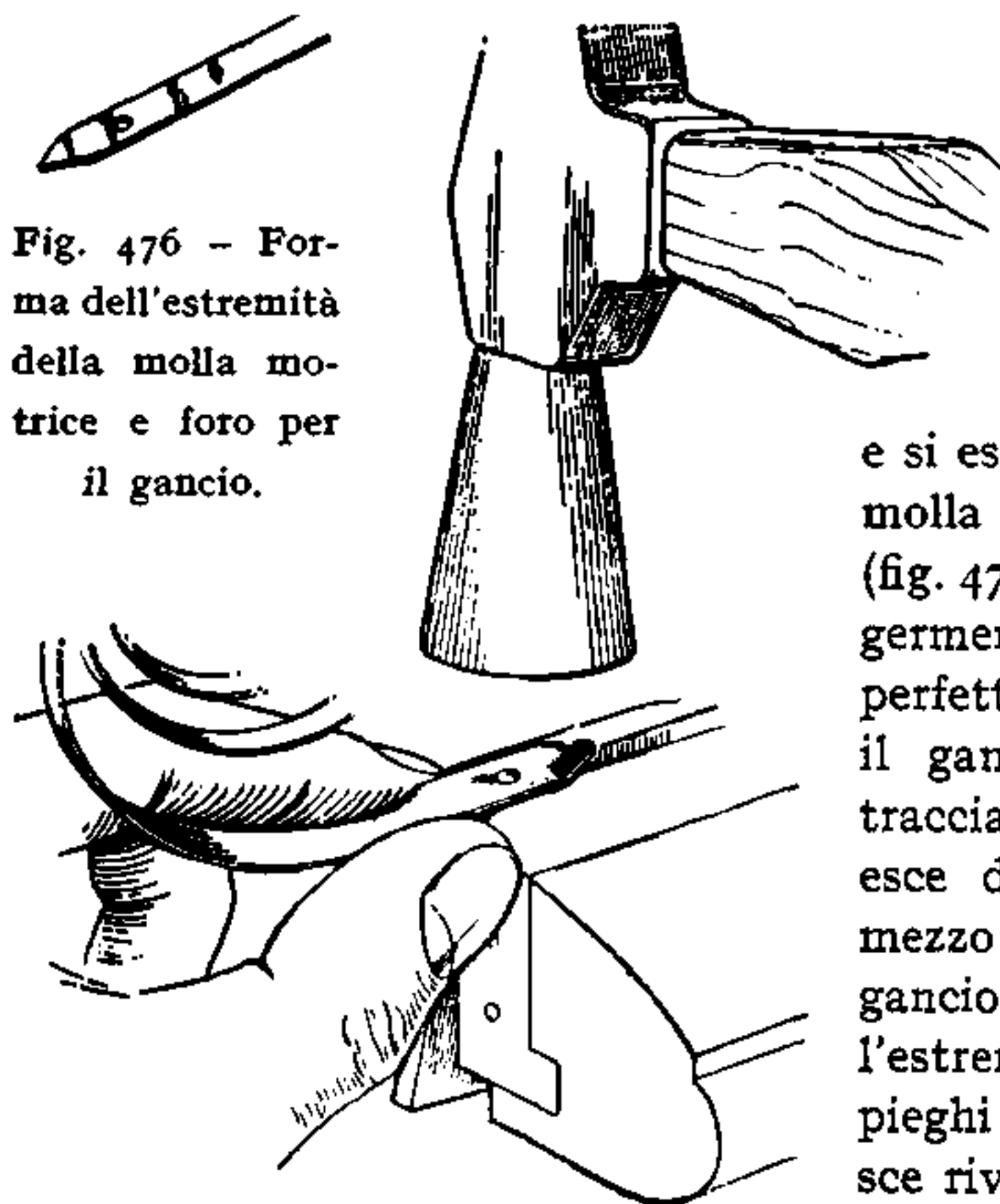
Fig. 477 - Ribattitura del gancio sulla molla motrice
