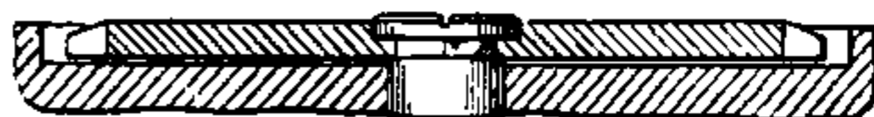
Fig. 182 - Rocchetto del bariletto che lega perchè la battuta dell'albero del bariletto non sporge dalla platina.
