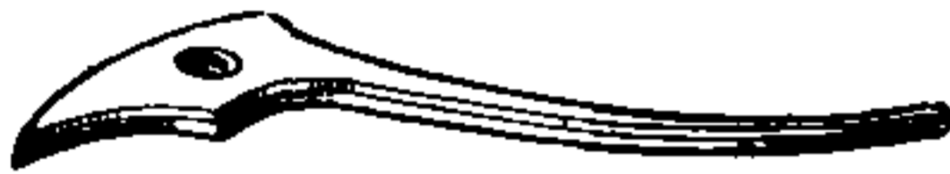
Fig. 275 - Molletta per cricchetto finita. Si osservino gli spigoli smussati.
