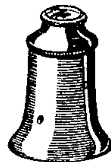
Fig. 14. Lente con distanza focale di 6 mm.
