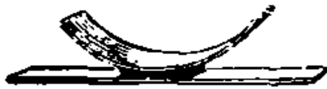
Fig. 164 - Illustrazione dell'adesione per capillarità. L'olio viene tenuto riunito tutto in un solo punto per effetto di questa proprietà.
