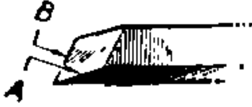
Fig. 289 - Si deve togliere ogni bava in A e B.
