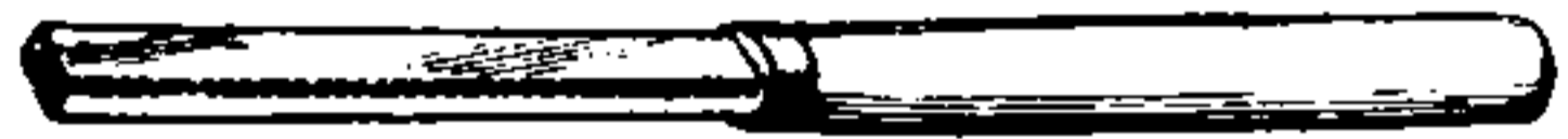
Fig. 347 - Rullatore da impiegare con il tornietto per lucidare, si osservino gli spigoli arrotondati.
