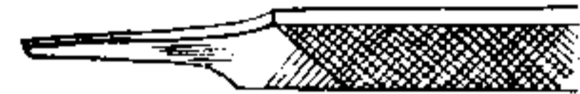
Fig. 95 - Utensile per tornire, fatto con una vecchia lima.
